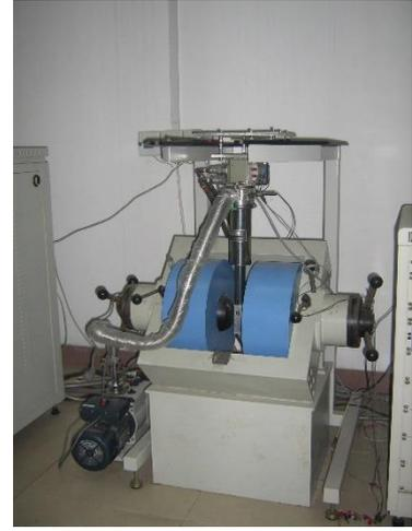
3、高低温磁电输运测量系统 (10 K ~ 450 K, 0 ~ 1.5 T)
