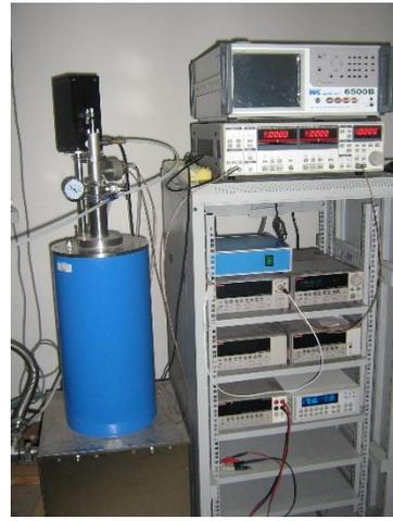
2、交流磁化率测量系统 (20 K ~ 500 K, 0.001 Hz ~ 2 MHz)
